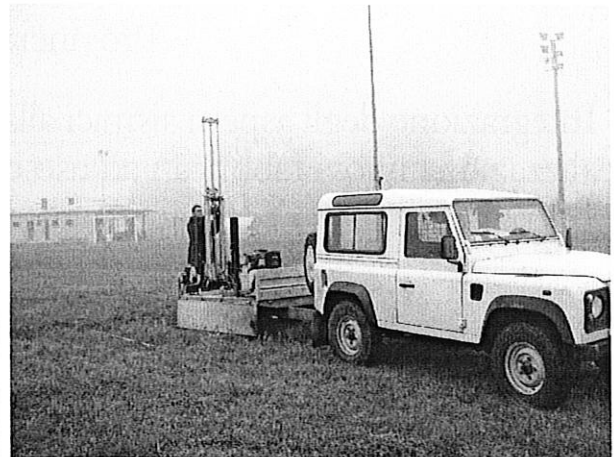
FASE DI ESECUZIONE PROVA PENETROMETRICA CPT1 E CAMPIONE INDISTURBATO
