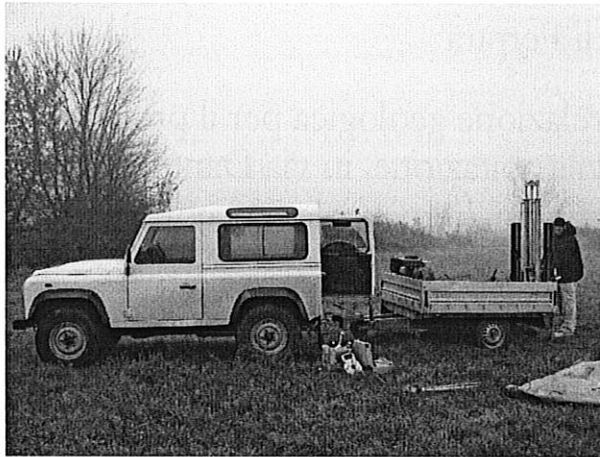
FASE DI ESECUZIONE PROVA PENETROMETRICA CPT1 E CAMPIONE INDISTURBATO
